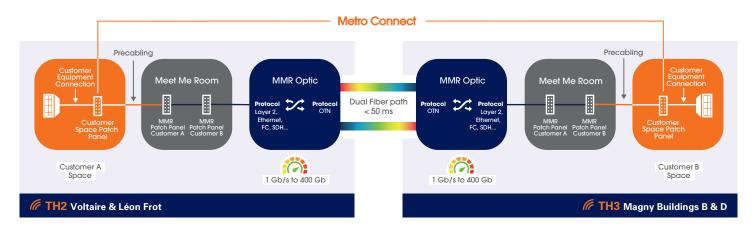
Les Meet Me Rooms de TH2 et TH3 sont dorénavant interfacées et complètement intégrées grâce à deux fibres redondées qui vous offrent un service sécurisé et une performance inégalée sur des liens à haute capacité, partant du patch panel du client A au patch panel du client B.
